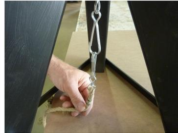
\* Glissez les mousquetons avec les petites boules dans les anneaux de charge par en dessous.
